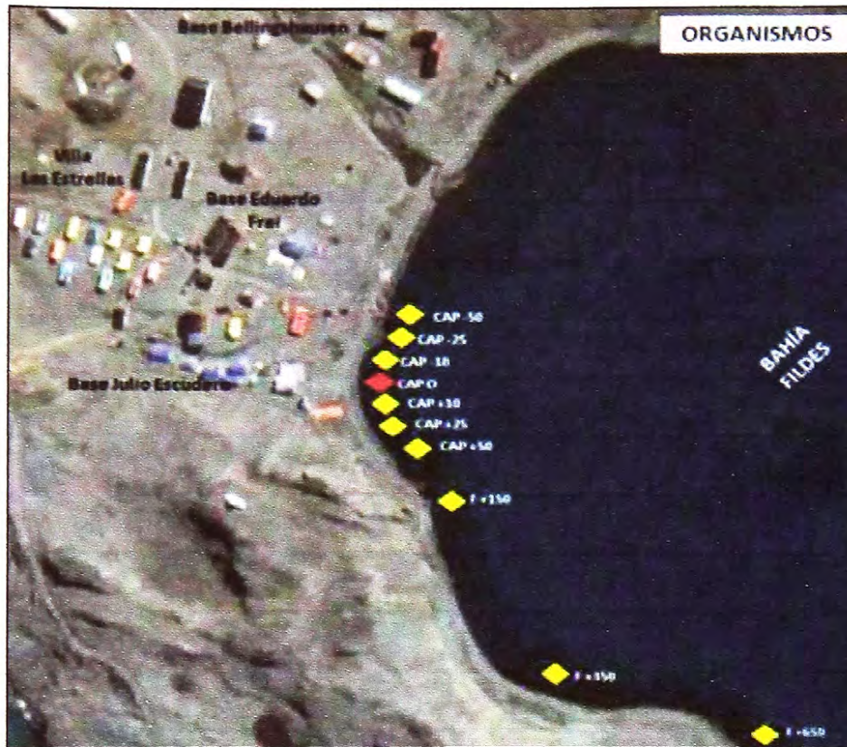
Fig. 7.-Distribución de las estaciones de muestreo de Nacella concinna en el borde costero Bahía Fildes. En color amarillo las estaciones distribuidas a 10, 25 y 50 metros desde el efluente de descarga líquida CAP 0 (estación de color rojo).
