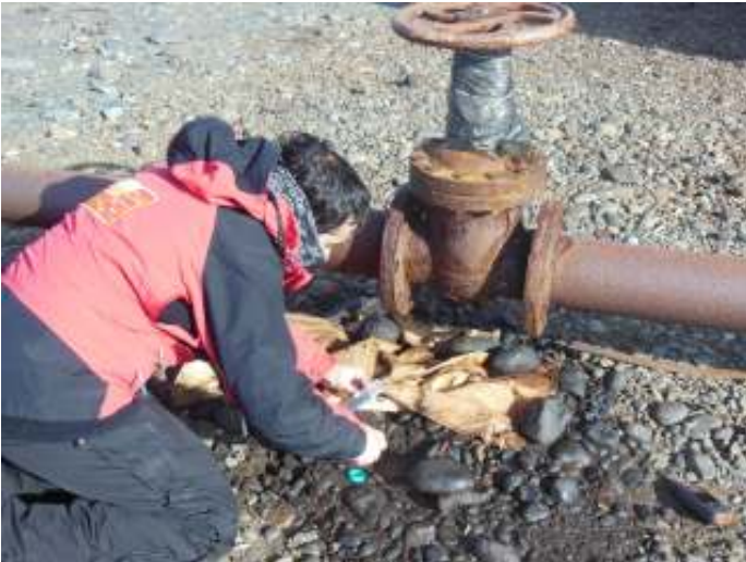
Fig.12 Fuga de Petróleo en Ducto en Mal Estado de Conservación en Isla Rey Jorge.
