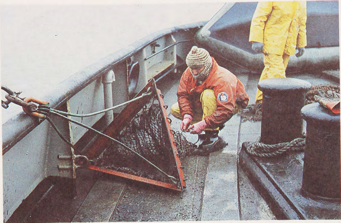
Fig. 6. La rastra cualitativa es cerrada momentos antes de proceder a la obtención de una muestra, en otra estación dentro de bahía Foster. Los arrastres suelen ser exitosos pues queda retenido en la red todo lo que la rastra encuentra en su "barrido" por el fondo. (Foto : R. Quintana).
