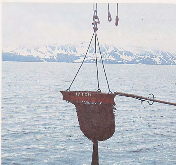
Fig. 4. Bahía Foster, isla Decepción. Después de un arrastre por el fondo durante aproximadamente 1 minuto, a 1 nudo, la rastra triangular para muestreo cualitativo es subida a bordo de la escampavía "Yelcho" con valiosas muestras, que incluyen sedimento y fauna (Foto : R. Quintana).
