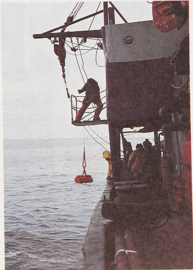
Fig. 7. La draga, tipo Van Veen, de 0.1 m 2 es izada a bordo de la escampavía "Yelcho" con una muestra de fondo marino obtenida en las cercanías de los "Fuelles de Neptuno", isla Decepción. En el muestreo cuantitativo con draga, sea tipo Van Veen, Petersen o Smith Mc Entyre, es de vital importancia comprobar que el instrumento venga bien cerrado, según se aprecia en la fotografía. En fondos rocosos, muchas veces hay que repetir la toma debido a que trozos de rocas quedan "mordidos" por ambas palas de la draga en su borde, y durante el ascenso a la superficie se produce pérdida de muestra y sedimento. (Foto : R. Quintana).
