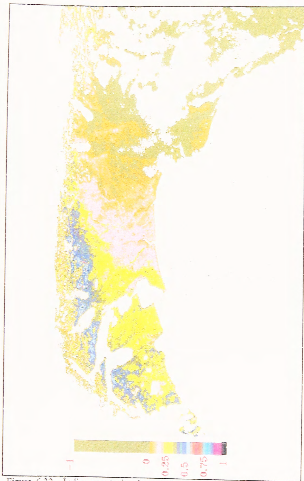
Figura 6.32.- Índice vegetal normalizado (NDVI) obtenido para la imagen NOAA-AVHRR SE3BHI19.1B2. El color café corresponde a tierra árida, sin vegetación verde. Se eligieron los colores de forma que exista un gran contraste entre uno y otro, de forma de ser fácilmente identificables.
